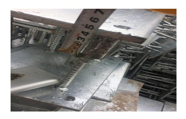
地脚螺栓为螺纹 18 的镀锌钢筋,长度为 200MM;
